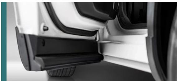
Большие дверные проемы для удобного доступа к пассажирским местам. Дополнительная пластиковая накладка для защиты двери и от попадания грязи в салон.
