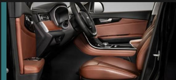
Сиденье водителя с электрорегулировкой в 6-ти направлениях, удобным профилем, массивным подголовником и хорошо выраженной боковой поддержкой обеспечивает высокий уровень комфорта.
