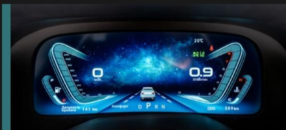
Панель инструментов: 10,25 дюймовый LCD экран с возможностью выбора 2 стилей (спорт и модерн).
